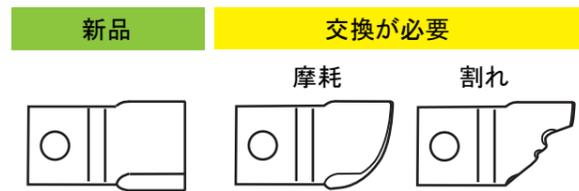
ナイフにヒビ、割れ、摩耗が無い点検してください。交換の際には必ず純正部品を使用してください。
