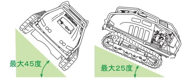
傾斜地での作業は、走行する向きと作業角度を取扱説明書で確認し、転倒事故に注意して行ってください。作業角通度を超える傾斜での使用は大変危険です。
