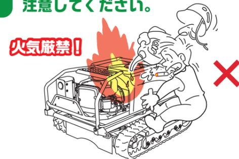
燃料の給油や潤滑油の給油・交換をするときは、平坦地でエンジンを止め、本機とプロポ送信機の電源が切れた状態で行ない、こぼれた燃料は必ず拭き取ります。
