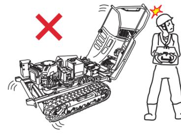
保護カバー類が外れたままエンジンをかけたり運転作業を行なうと、機体の破損やケガの原因になるので、元のとおり装着してください。
