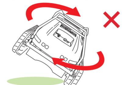
傾斜地で急発進、急加速、急旋回、および急停止を行うと本機がスリッパしたり、転倒したりする恐れがあります。傾斜地では本機を見下ろす位置で操作を行なってください。
