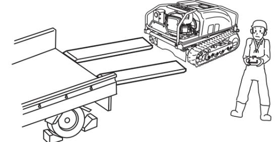
アユミ板は強度・幅・長さの十分ある、スリッパしない物を使用してください。本機の刈高さを最高に設定し、アユミ板上で方向修正せず、微速で走行してください。
