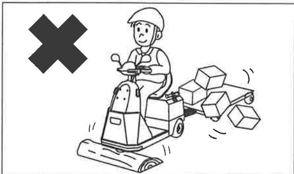
(8) 牽引作業は、平坦・前進操作が基本です。斜面使用可能傾斜角度 3° 未満を走行する場合でも、斜面を横切ったり、斜めに走行したり、斜面での旋回は避けてください。
