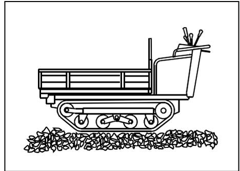
砂利道のような、小石がたくさんある場所では、急ターンや半径の小さい蛇行運転は避け、直進や小さい角度の方向転換の運転をするよう、注意してください。
