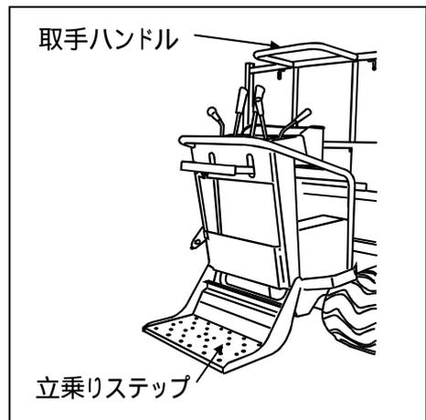
立乗りステップの収納は、持ち上げて左側のフックにステップのリベットをかけて、固定してください。
