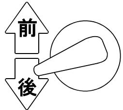
(4)変速ダイヤルを「低速」側へ回してください。
