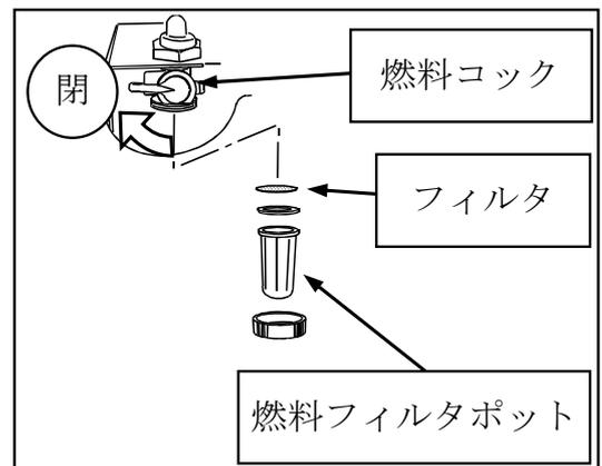
(2) 燃料漏れがないよう元の通りに確実に組み付けてください。
