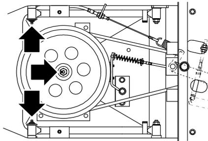
(3) キングピン、センターピン、ブレーキペダル支点(合計4箇所)
