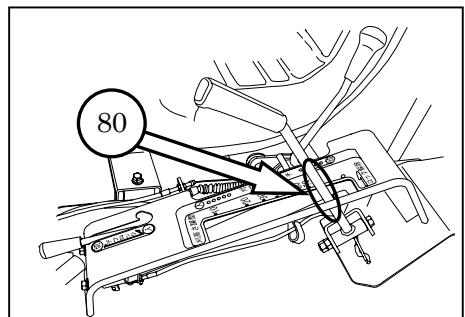
**重要** ●刈高さ調整レバーを操作する際は、必ずレバーを座席側へ傾け「ロック」を解除してから上下操作をしてください。「ロック」を解除しないで無理に操作すると故障の原因となります。
