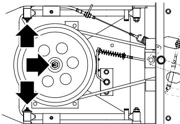
(3) キングピン、センターピン、ブレーキペダル支点(合計4箇所)
