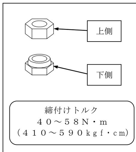
**危険** ●上下のナットを同時に締付けしないでください。ナットの締付力が不足し、ナットの緩みが発生します。その場合、刈刃が飛散し、周囲の人や物に当たり、重大な事故を招く恐れがあります。
