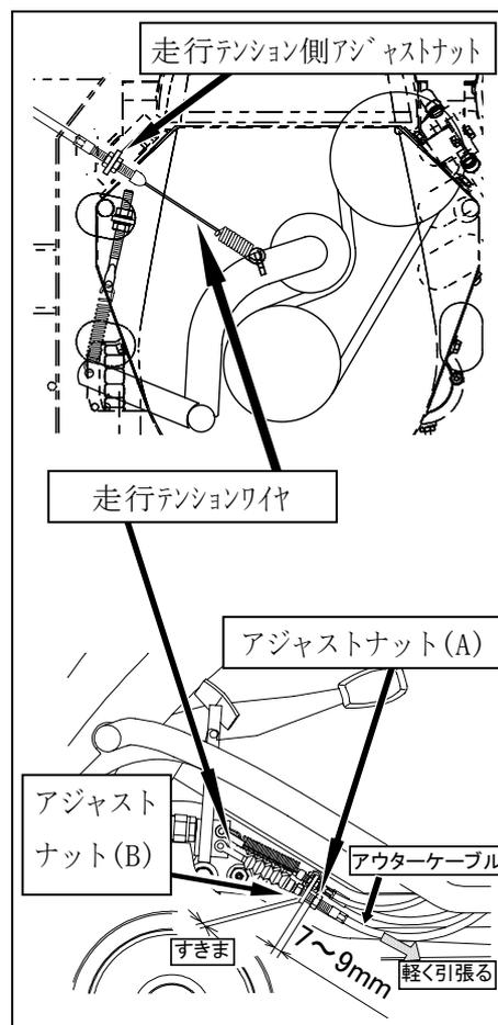
走行テンションワイヤを交換した場合は右図の方向に走行テンションワイヤのスプリングを走行テンションに組付けてください。
