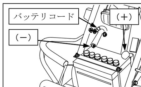
(3) バッテリーを固定しているプレートを外して、バッテリーを本機から取り出し、充電を行なってください。
