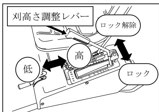
刈高さが高いときにレバー上部を上に引つぱり前に倒すと、レバーの高さを低くできます。レバーが板に引掛りにくくなります。
