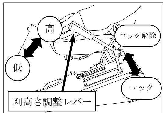
刈高さが高いときにレバー上部を上に引つぱり前に倒すと、レバーの高さを低くできます。レバーが枝に引掛りにくくなります。
