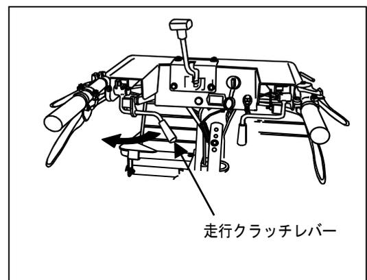
作業を停止する場合は、まず変速レバーを「中立」位置にして本機を停止させ、走行クラッチレバーを「切」にすると、同時に駐車ブレーキがかかります。
