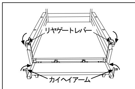
**重要** ●マエワク水平固定状態で、ダンプ操作をしないでください。枠・荷台が破損します。
