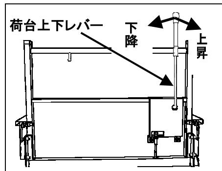
**重要** ●リフト・ダンプ切換レバーがダンプ位置の時、荷台上で操作すると荷台がダンプし危険です。リフト位置で固定フックにより、確実に固定されていることを確認してから操作してください。
