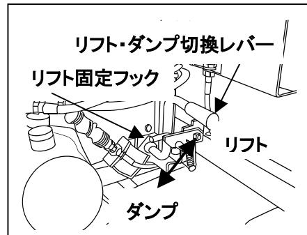
**重要** ●リフト・ダンプ切換は、荷台が確実に降りきった状態で行い、荷台が少しでも上昇している時は絶対に切換ないでください、切換フックが破損します。
