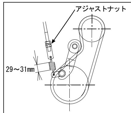
**重要** ●走行クラッチの調整が不十分な場合には、走行クラッチレバーを「入」にしてもベルトがスリップして、動力の伝動が悪くなり、走行できなくなったり、坂道で暴走する恐れがあります。作業前には必ずベルトをチェックしてください。
