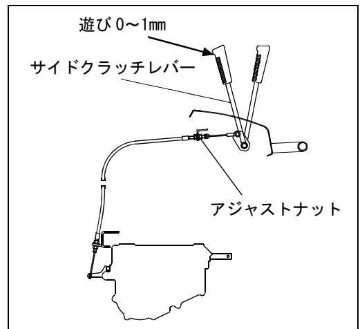
**重要** ●サイドクラッチレバーの調整でケーブルを引き過ぎるとギヤボックス内のサイドクラッチギヤが抜けたままとなり、走行不能となる場合があります。レバーに少しガタをもたせるように調整してください。
