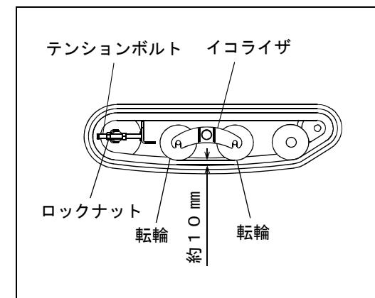
**重要** ●クローラが張り過ぎていたり緩んでいると、ホイルスプロケットの磨耗やクローラの脱輪及び切断・亀裂発生の原因となります。始業前には、クローラの張り具合を点検してください。
