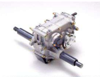
メカ式 T/M ・6馬力入力・変速段数 F2.R2 ・爪式サイドクラッチ
