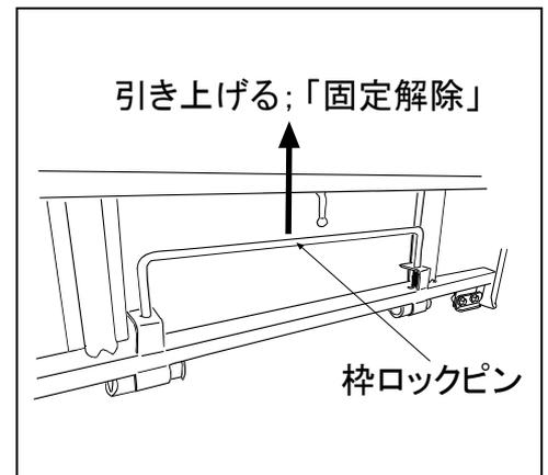
**▲注意** ● 枠をスライドさせたり開閉させたりした後は、枠が確実に固定されていることを確認して必ず固定した状態で使用してください。
