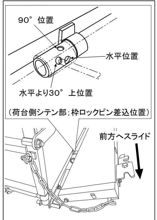
**重要** 横枠を倒して使用する場合には、前枠は荷台から外すか、荷枠パイプを差し込んで固定した状態で使用してください。
