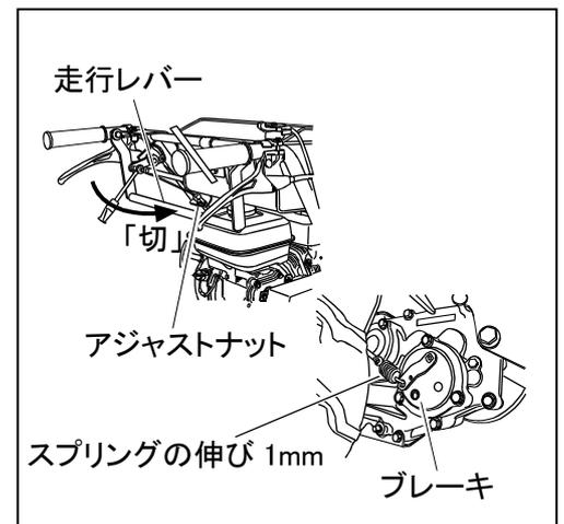
**⚠️ 注意** ●ブレーキの調整が不十分な場合、走行レバーを切ってもブレーキが効かず機体が自然に動きだす（特に傾斜地）恐れがあり大変危険です。
