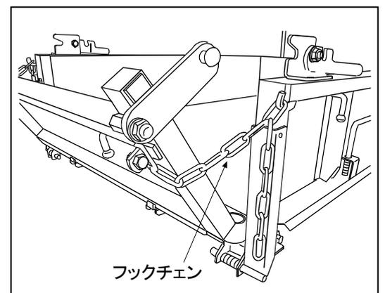
■ X G 3 5 5 H F 三方開閉式柵の使用方法（前柵；ダンプ時）
