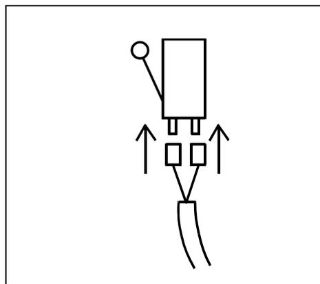
(3) フォークの上昇でスイッチが押されているか確認してください。「カチッ」と音がするまで押されているか確認してください。
