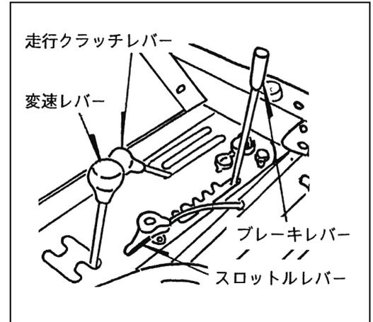
**重要** ●駐車ブレーキを掛けたままの状態でもエンジン高回転・低速走行（トルクが高い）では、発進してしまいます。そのまま走行すると短時間でブレーキが効かなくなるばかりでなく、誤操作の原因となります。
